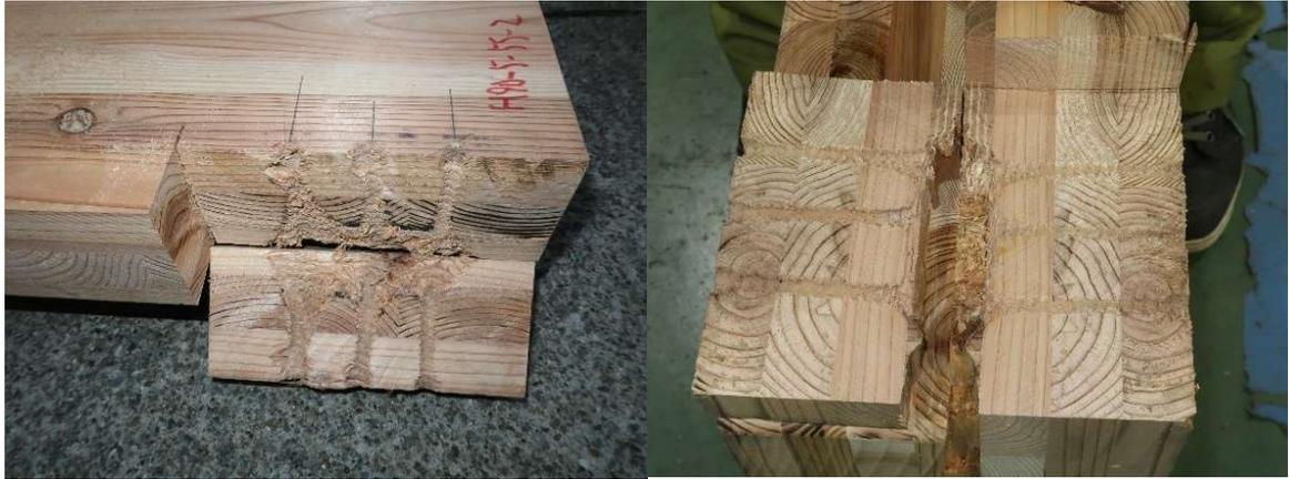
写真 4.1-1 4d 弱軸試験体の試験後の様子 (H90-5-7W)
