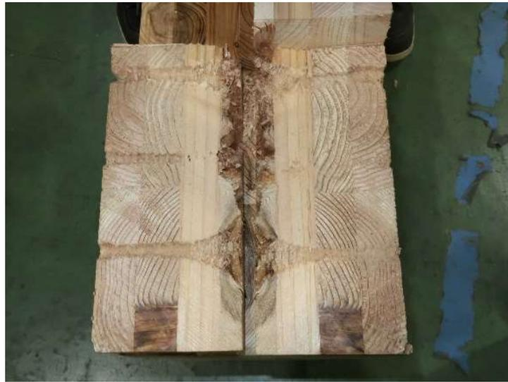
写真 4.1-2 8d 弱軸試験体の試験後の様子 (H90-5-7W8d)
