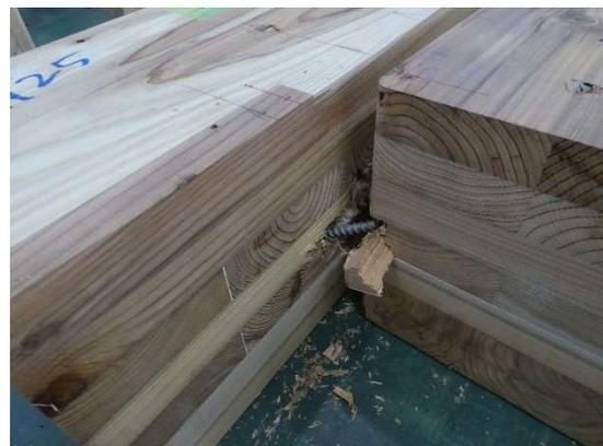
写真 3.4.3-8 NO.3 X90-5-7S-5 ビスの折損、木材の割れ
