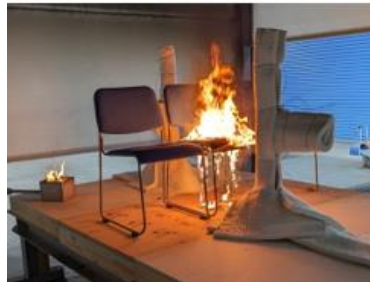
写真 6.12 中央椅子座席部の燃焼
