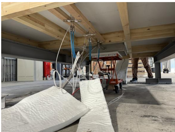
写真 4.2.5 熱流計冷却水配管設備とプロパンガス用マスフローメーター
