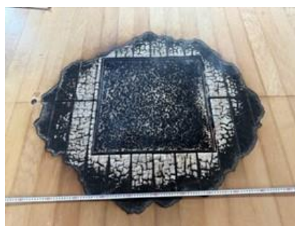
写真 4.2.15 床上の燃焼した範囲（実験 8）
