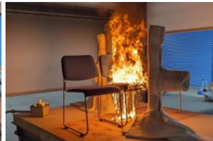
写真 6.13 中央椅子座席部 および背もたれ部の燃焼
