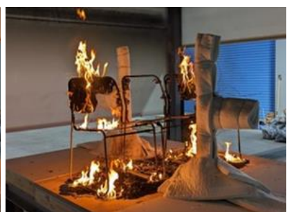
写真 6.16 左右椅子の 背もたれ部 および床上での燃焼状況
