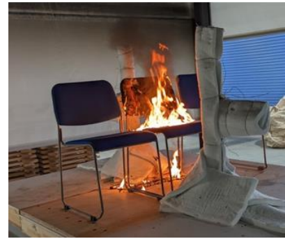
写真 6.23 座席の燃焼拡大
