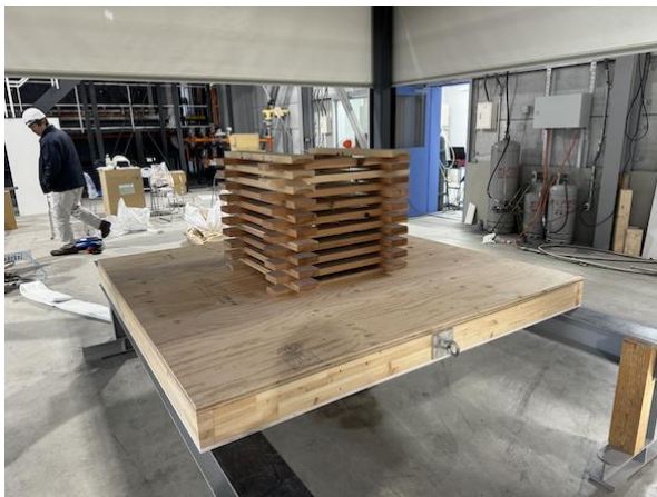
写真 4.2.2 木製クリブ火源による木質床の燃え拡がり性状確認実験の様子 (クリブサイズ：スギ 30×105×750mm×20 本を用いた 10 段組)
