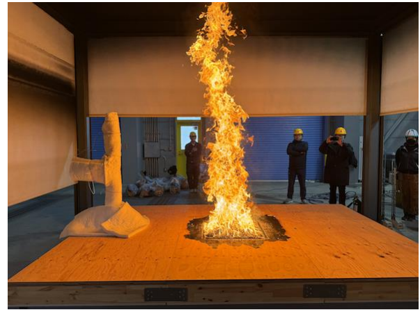
写真 4.2.1 プロパンガスバーナーによる木質床の燃え拡がり性状確認実験の様子 (バーナーサイズ：0.5m×0.5m)
