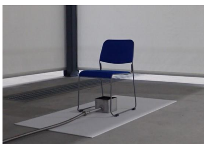
写真 6.4 バーナーの設置
