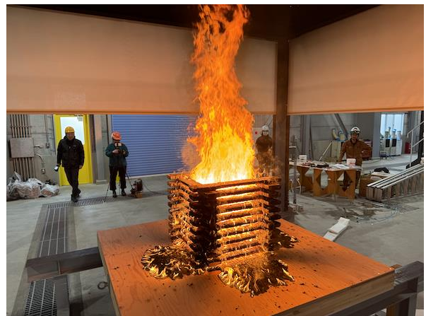
写真 4.2.2 木製クリブ火源による木質床の燃え拡がり性状確認実験の様子 (クリブサイズ：スギ 30×105×750mm×20 本を用いた 10 段組)
