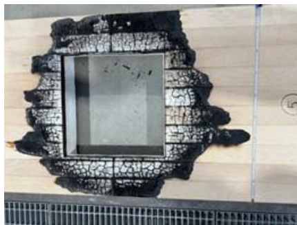
写真 4.2.13 床上の燃焼した範囲（実験 5）
