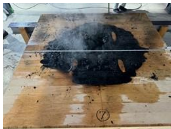
[床実験 3] 構造用合板厚 28mm (クリブ 2ヶ縦積み)
