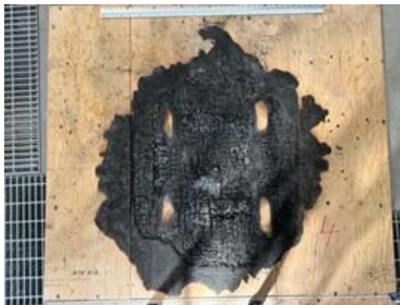
[床実験 6] 構造用合板厚 15mm 上にフローリング厚 18mm (クリブ 2 ヶ縦積み)
