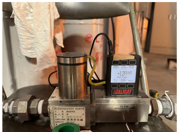
写真 4.2.5 熱流計冷却水配管設備とプロパンガス用マスフローメーター
