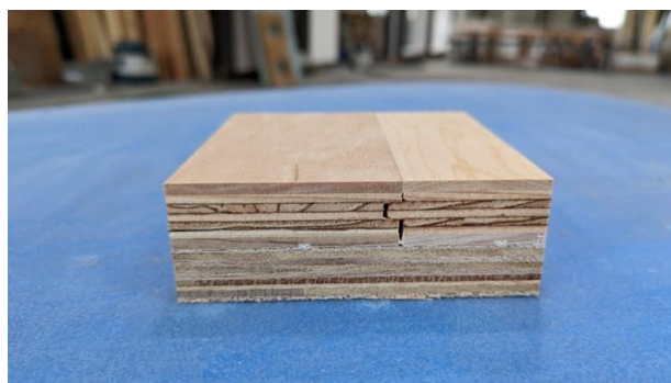
写真 5.2.1 E フローリングの試験体
