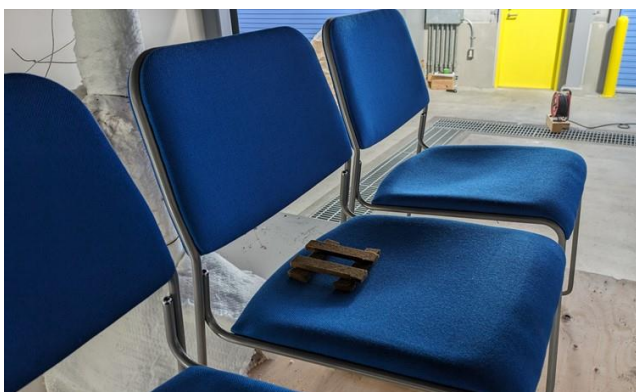
写真 6.20 着火剤の設置状況
